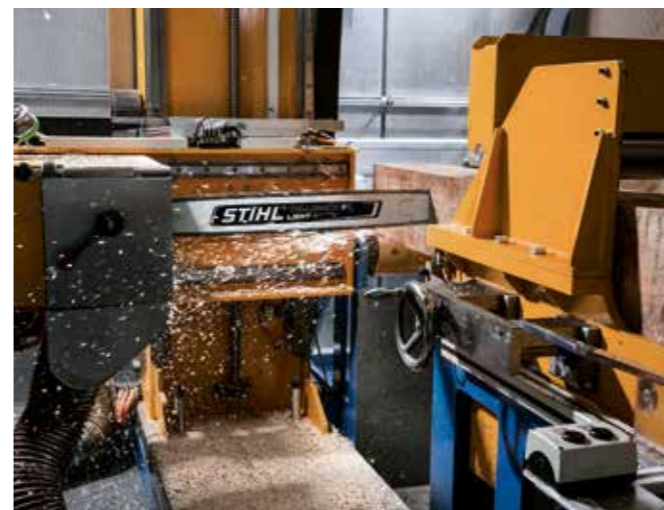
Die ständige Materialprüfung auf verschiedenen Prüfständen trägt zum hohen Qualitätsstandard der STIHL Produkte bei.
